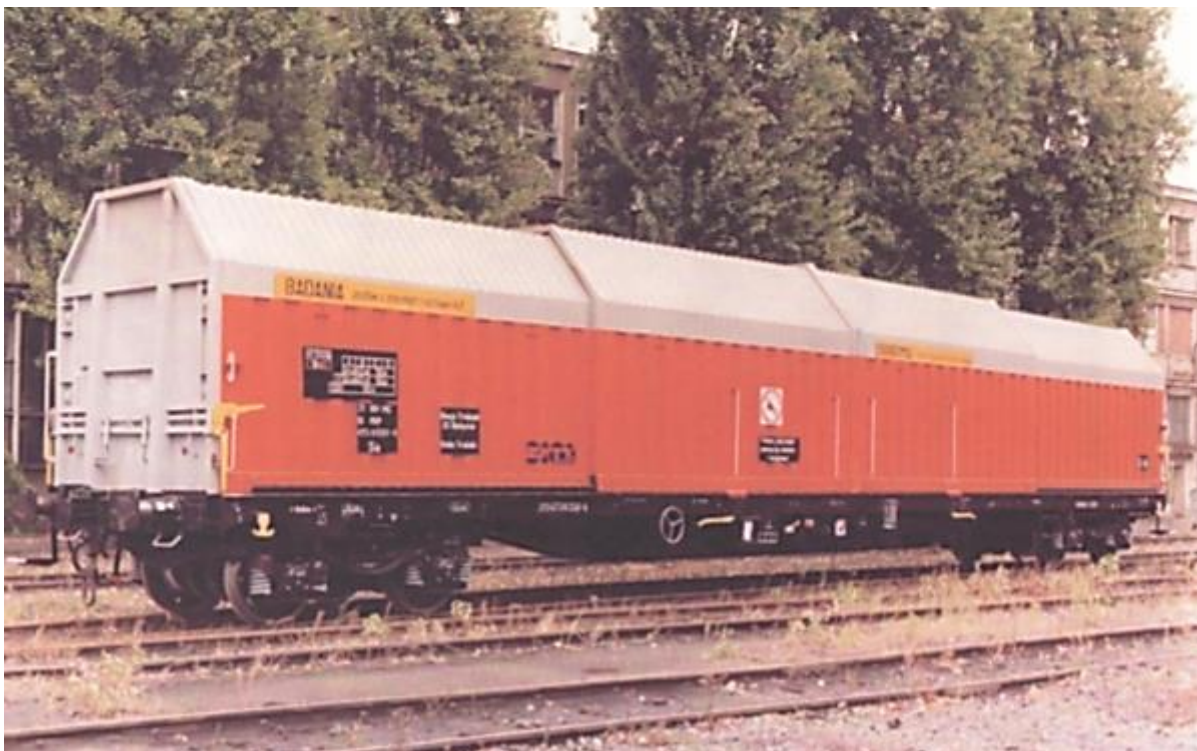
Rys. 7. Wagon towarowy typu 426Sc z wózkami 4RS/N [25].
