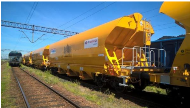
Rys. 4. Do transportu zboża Grupa Kapitałowa OT Logistics będzie wykorzystywać nowoczesne wagony typu Tagnpps, które niedawno wydzierżawiła. Masa ładunkowa każdego z nich to ok. 60 ton [20].
