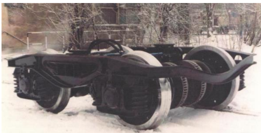
Rys. 6. Wózek 4RS/N do wagonów towarowych o nacisku 20÷22,5 t/os, V=120 km/h [25].
