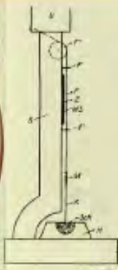
Szkielet krystalizacji metali przez wypalanie w strupie (Czochralski, Wst. fizykalnochem. Chemik , 1914)
